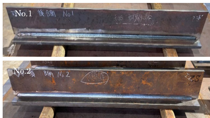
図 6 溶接後の外観写真
