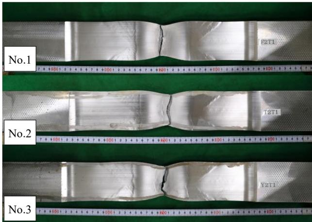
図6 継手引張試験後の試験片
