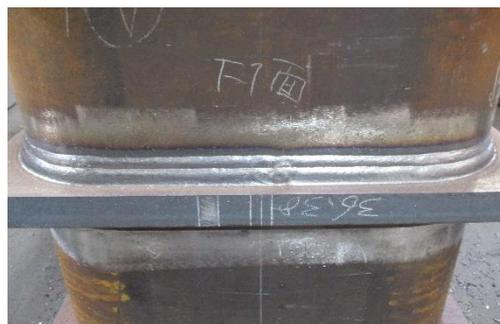
図 2-7 試験体 No.1 溶接ビード
